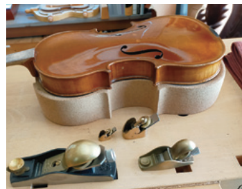
上:日本とは形状も使い方も違う鉋 下:部位部品によって工具を使い分ける
